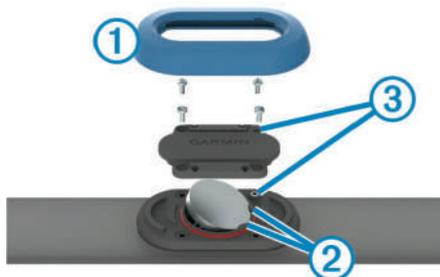
2 С помощью малой крестовой отвертки (00) открутите четыре винта на передней поверхности модуля.
