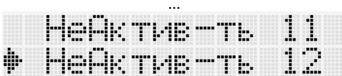
Войдя в режим, с помощью кнопок «вверх»/«вниз», можно перемещаться между параметрами активности и неактивности всех двенадцати нагрузок. Выбрав параметр с помощью ENTER, пользователь получит доступ к настройке этого параметра.
